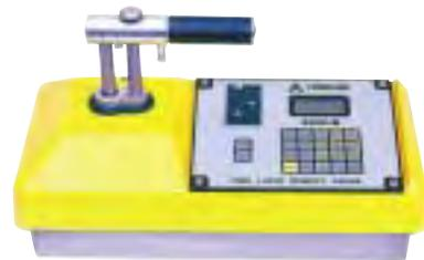
Die Schichtdicke ist von 2,54 cm bis 10,15 cm über die Tastatur einzugeben. Die Sonde ist für Asphaltbeläge zwischen 1600 und 2700  $\text{kg}/\text{m}^3$  Dichte einsetzbar.
