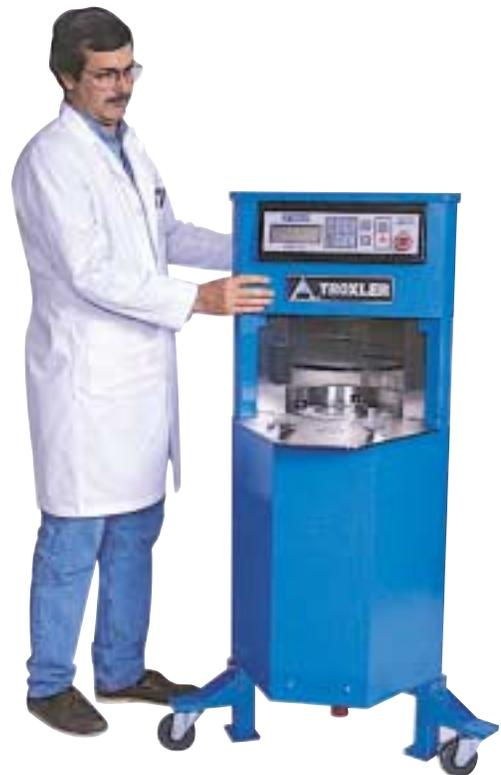
SHRP/Superpave™ Gyrotory Compactor wird in Zukunft den Marshall-Hammer ersetzen, da der Marshall das Hüpfen einer Walze bei Walzgang simuliert. Der Gyrotory wälkt die Asphaltprobe und verdichtet dabei mit einem konstanten Druck vom 600 kPa.
