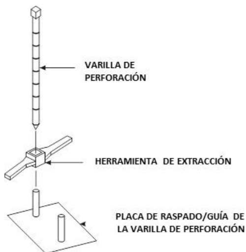
Figura 9. Posicionamiento de la varilla de perforación
